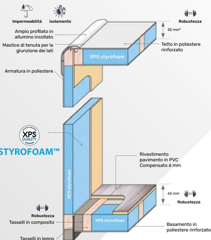
\* Nota: per via della forma particolare, il tetto dei nostri mansardati/profilati S è progettato con una tecnologia specifica, spessore 35 mm, isolamento EPS.
