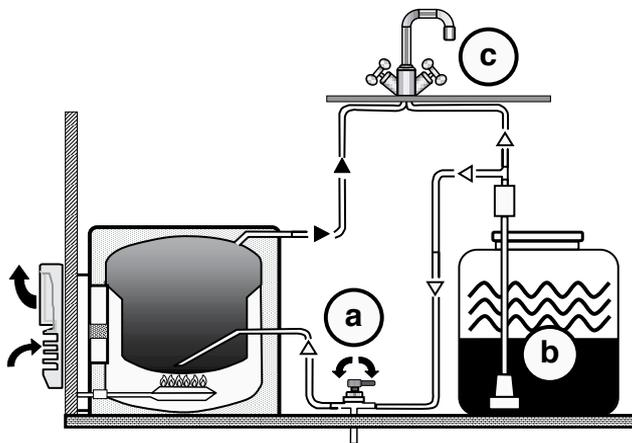
mitigeur mono commande sur « chaud »), jusqu'à ce que le chauffe-eau soit rempli d'eau, que tout l'air soit sorti, et que l'eau coule.
