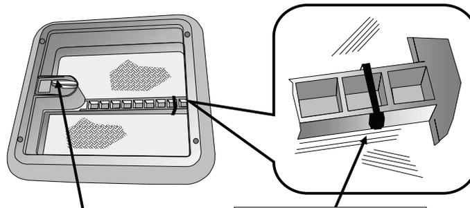
Tourner à fond la manivelle pour obtenir une fermeture optimale
