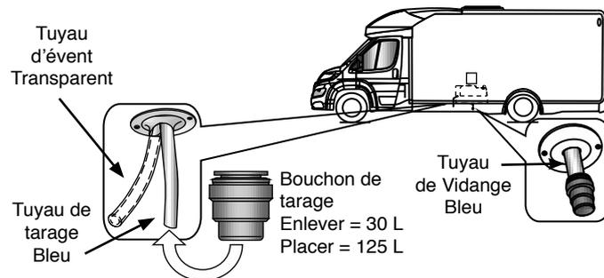
Pour mettre le bouchon il suffit de l'enfoncer en entièrement sur le tuyau.
