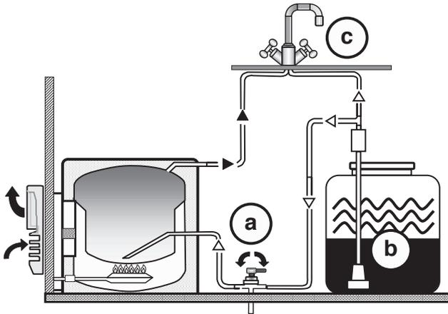
Mischbatterie auf « warm »), bis der Warmwasserbereiter mit Wasser gefüllt, die Luft entwichen ist und das Wasser läuft.
