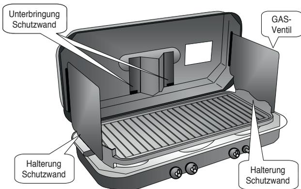
Anmerkung: auf der Plancha-Rückseite stoppt ein Sicherheitsgasventil die Versorgung beim Schließen der Haube.
