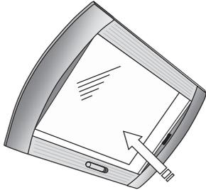
Korrekte Verriegelung prüfen; dazu auf die Scheibe drücken. Wenn sie sich öffnet, noch einmal schließen / verriegeln
