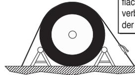
Beim Transport des Reisemobils auf einer Ladefläche (Lkw, Bahn, Schiff usw.) Die Befestigung muss durch Verkeilen und Festzurren der Reifen erfolgen.
