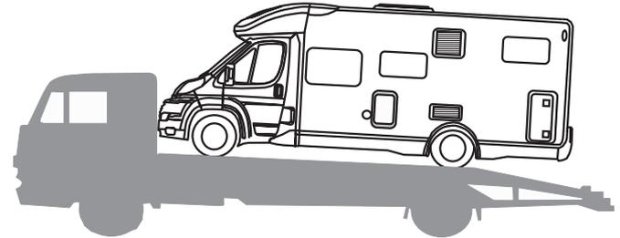
Beim Transport des Reisemobils auf einer Ladefläche (Lkw, Bahn, Schiff usw.) ist es strengstens verboten, das Reisemobil mit dem Fahrgestell an der Ladefläche zu befestigen.
