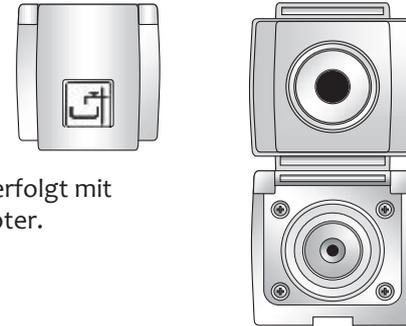
Das Füllen erfolgt mit einem Adapter.
