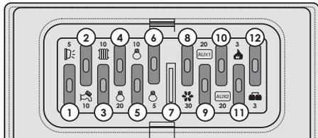
1 15A Sicherung für die Versorgung des Vorzeltlichtes, sie hängt vom Vorzeltlicht Taster ab und schaltet sich automatisch ab bei laufenden Motor.
