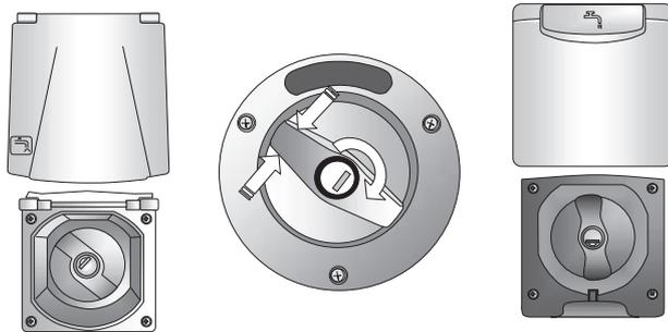
Zum Öffnen und Schließen des Verschlusses mit dem Schlüssel muss er in Position gehalten werden, um beim Drehen des Schlüssels im Schloss ein Mitdrehen zu vermeiden.
