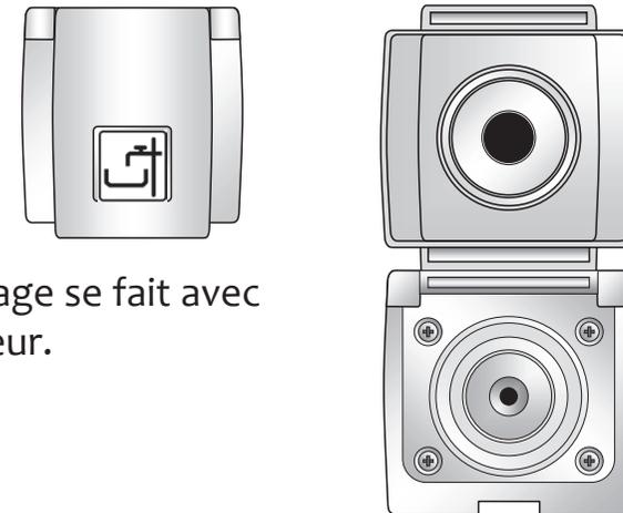
Le remplissage se fait avec un adaptateur.
