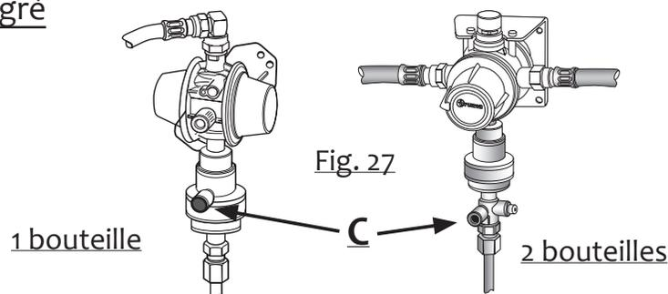
Dans le cas de freinage brusque ou de collision le capteur interrompt le flux de gaz.
