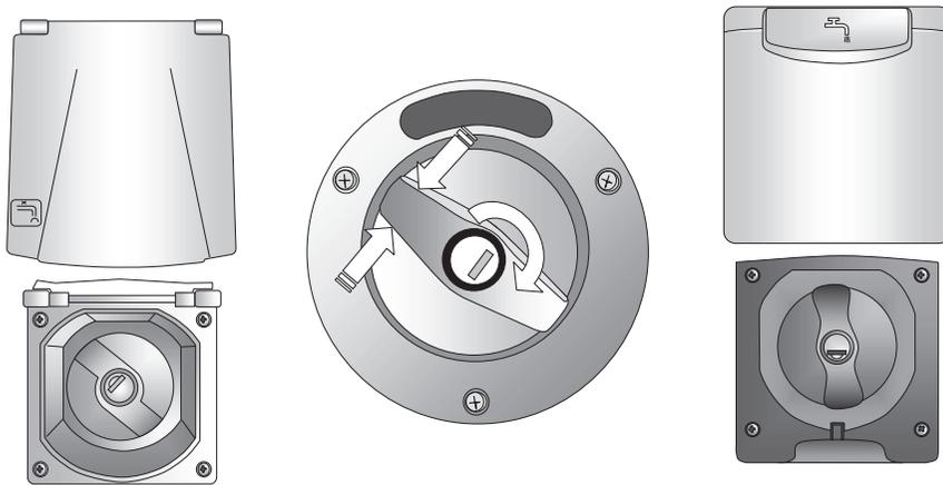
Pour l'ouverture et la fermeture du bouchon avec la clé, il faut maintenir le bouchon dans sa position afin d'éviter une rotation lorsque vous tournez la clé dans la serrure.
