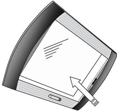
Vérifier le bon verrouillage par une poussée d'ouverture sur la vitre. S'il y a ouverture refaire la manœuvre de fermeture / verrouillage
