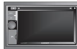
La caméra de recul fonctionne avec le contact et la marche arrière engagée.
