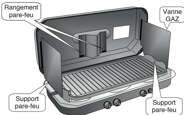
Nota : à l'arrière de la plancha une vanne gaz de sécurité stoppe l'alimentation en cas de fermeture du capot.
