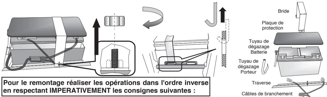
Vérifier que le faisceau électrique n'a pas été endommagé lors des opérations. Graisser légèrement les bornes.
