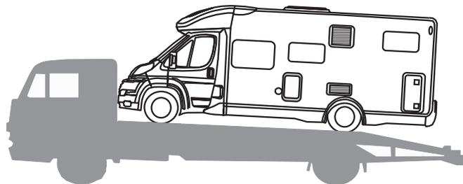
En cas de transport du camping-car sur un plateau (Camion, train, bateau...) il est strictement interdit d'attacher le camping-car au plateau par le châssis
