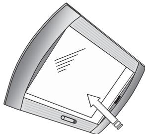
Vérifier le bon verrouillage par une poussée d'ouverture sur la vitre. S'il y a ouverture refaire la manœuvre de fermeture / verrouillage
