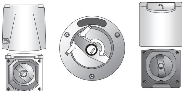
Pour l'ouverture et la fermeture du bouchon avec la clé, il faut maintenir le bouchon dans sa position afin d'éviter une rotation lorsque vous tournez la clé dans la serrure.
