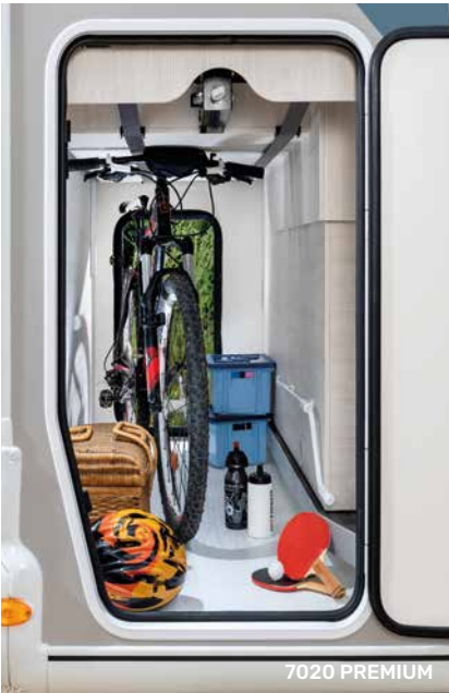
De verwarmde, verlichte opbergruimte met siorhaken, stopcontacten 12 V/230 V en 2 toegangsdeuren
