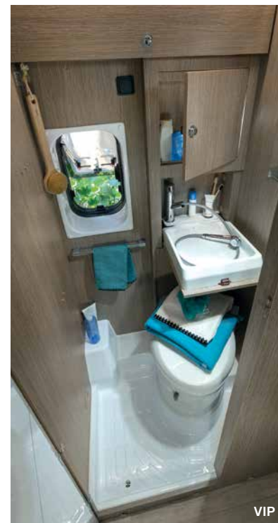
Doucheruimte met raam en opklapbare wastafel
