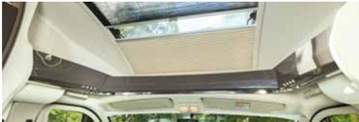
**Tetto panoramico** di cabina, apribile, con oscurante e zanzariera. Spazi portaoggetti termoformati al di sopra della cabina con **illuminazione a LED** indiretta su ciascun lato.
