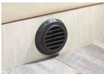
**Riscaldamento utilizzabile in marcia**, l'ideale per i passeggeri ma anche molto pratico per poter scaldare la cellula prima della tappa.
