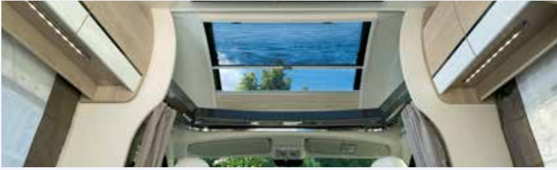
Zonnedak van de cabine, kan geopend worden, met verd uisteringsgordijn & hor. Thermogevormde opbergruimten boven de cabine met indirecte LED-verlichting aan iedere kant.
