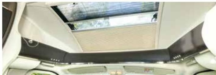
**Panoramadach** der Kabine zum Öffnen, mit Verdunklungsrollo und Moskitonetz. Thermogeformte Ablagen über dem Fahrerhaus mit **LED-Beleuchtung** auf jeder Seite.
