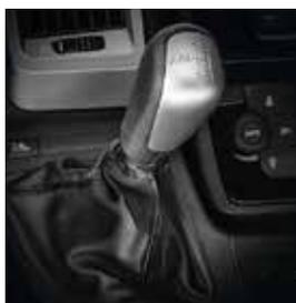
Es unterscheidet sich deutlich von Automatikgetrieben mit hydraulischem Drehmomentwandler, da es genauso schnell reagiert wie das handgeschaltete Getriebe: Es verwendet dieselbe 6-Gang-Mechanik, während Kupplung und Gangwahl elektrohydraulisch gesteuert werden.
