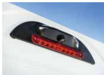
Rückfahrkamera in der Heckleiste integriert, mit Bildschirm am Rückspiegel.
