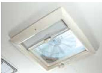
Die Dachhaube mit Ventilator/Entlüfter\*\*, entfernt die verbrauchte Luft und belüftet den Innenraum in kürzester Zeit.
