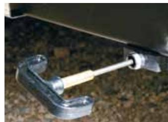
Sauberer **Entleeren des Abwassertanks** einfach mit dem seitlichen Zug!
