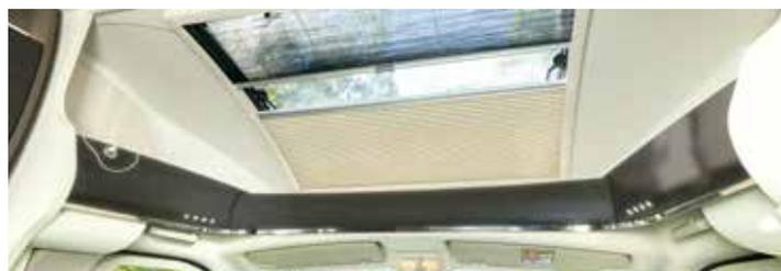
**Toit panoramique** de cabine, ouvrant, avec store occultant et moustiquaire. Rangements thermoformés au-dessus de la cabine avec **éclairage LED** indirect de chaque côté (profilés).
