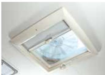
Le lanterneau ventilateur/extracteur\*\* permet une extraction de l'air vicié et une ventilation de l'intérieur en très peu de temps.
