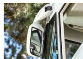
Rétroviseurs électriques type "autobus".
