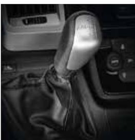
Elle se distingue nettement des boîtes automatiques avec convertisseur de couple hydraulique parce qu'elle offre la même rapidité de réaction que la boîte manuelle : en effet, elle utilise la même mécanique à 6 rapports, tandis que l'embrayage et le choix du rapport sont commandés par un actionneur électro-hydraulique.
