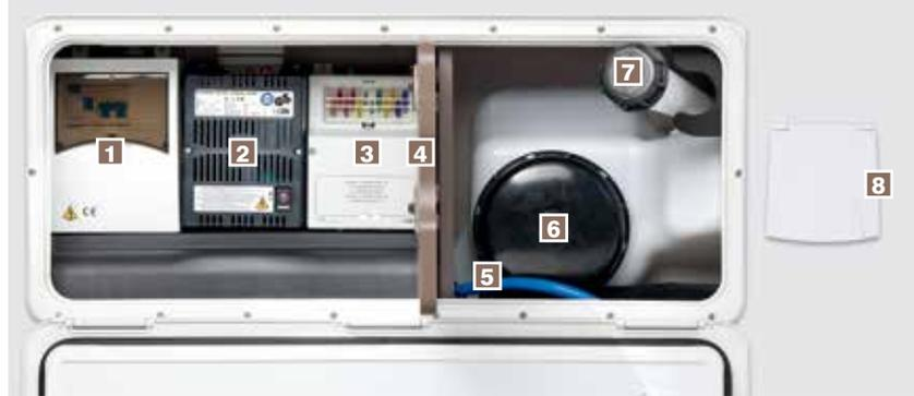
Die Technibox ist durch eine abschließbare dichte Klappe gesichert, mit Zugang zu 2 unterschiedlichen Technikbereichen:
