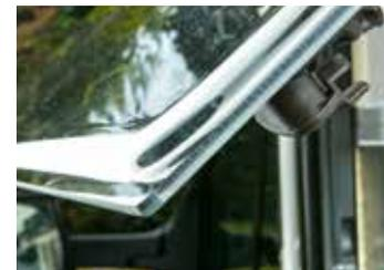
**Panoramadach** der Kabine zum Öffnen, mit Verdunklungsrollo und Moskitonetz. Thermogeformte Ablagen über dem Fahrerhaus mit **LED-Beleuchtung** auf jeder Seite.
